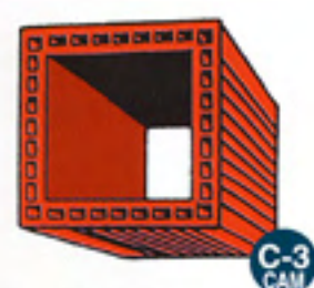
Modelo C - 3 CAM. Conducto Individual Medida exterior: 26 x 26 x 25. Peso: 10,00
